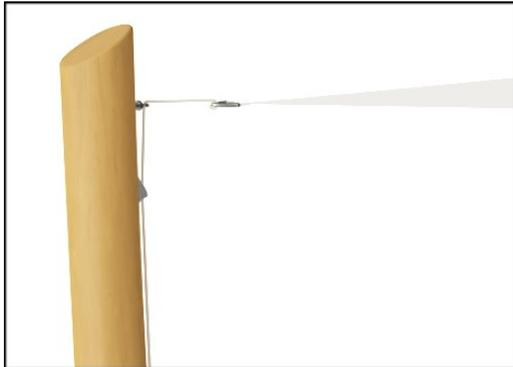
Das Seil wird mit einer Edelstahl-Ösenschraube am Robinienpfosten befestigt und durch einen Nylon-Bügel mit Keilschiene gespannt. Das System sorgt dafür, dass sich das Segel leicht anbringen, spannen und wieder abnehmen lässt.
