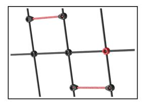
Seile aus UV-stabilisierten PES-Seilsträngen mit innerer Stahlseilverstärkung. Das Polyestergarn wird aus +95 % Post-Consumer-Materialien hergestellt und induktiv auf jede Litze aufgeschmolzen.
