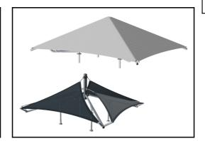
Die Sonnensegel bestehen aus Commercial 95 HDPE, einem gestrickten Sonnenschutztuch, das speziell für Sonnenschutzkonstruktionen hergestellt wird. Das Material ist mit UV-Stabilisatoren behandelt, um eine lange Lebensdauer zu erreichen. Die Segel werden von einem feuerverzinkten Stahlrahmen unterstützt. Geschlossenes Segel mit einem einfachen Abnahmesystem.
