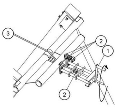
钢缆 3 通过特殊设计的装置张紧。通过旋转手柄 1，可以按照说明以安全的方式拉紧钢缆。张紧后，电缆将被三个夹子 2 锁定。张紧装置还可在年度检查期间用于调节。
