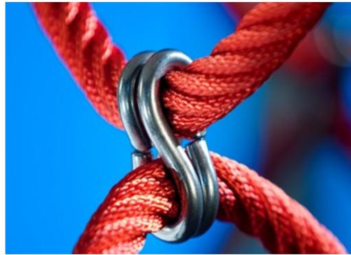
Die Corocord-S-Klemmen sind universale Verbindungselemente aus rostfreiem Edelstahl mit einem Durchmesser von 8 mm. Die Klemmenden sind abgerundet und das gesamte Bauteil wird mit hydraulischen Spezialwerkzeugen auf das Seil gepresst. Daher können die Klemmen mit herkömmlichen Werkzeugen nicht entfernt werden.
