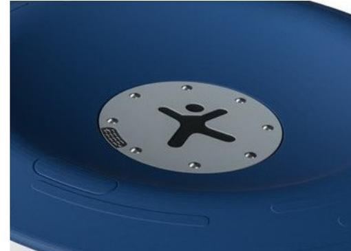
Die Spinner Bowls bestehen aus recycelbarem PE, das zu 33 % aus Post-Consumer-Materialien hergestellt wird. Die Schalen werden in einem Stück mit integrierten Metallgewindebuchsen und einem Wasserablaufloch gegossen, um eine hohe Lebensdauer in allen Klimazonen der Welt zu gewährleisten.
