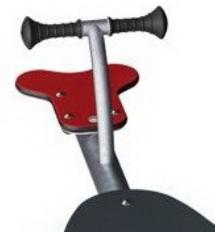
Griffe werden mit einer geformten PP-Inneneinlage und einer Außenschicht aus weichem TPV-Gummi hergestellt. Die Griffe sind mit einer Einlage aus verzinktem Stahl am Rohr befestigt, um Festigkeit und Haltbarkeit zu gewährleisten.
