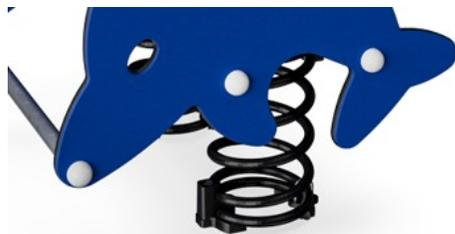
KOMPAN 弹簧由符合 EN10270 的优质弹簧钢制成。弹簧通过磷化处理进行清洁，然后将其涂上环氧底漆和聚酯粉末涂料作为上光油。弹簧通过独特的防夹配件固定，以实现最大的安全性和较长的使用寿命。
