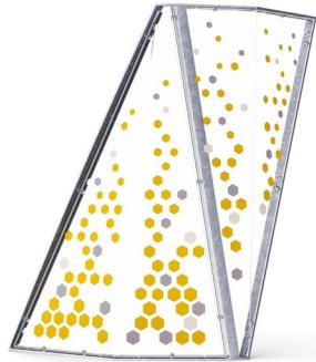
Die grafischen Tafeln sind aus hochwertigem Polycarbonat mit einer Dicke von 6 mm hergestellt. Der Grafikdruck besteht aus einer inneren Schicht, die das Bild darstellt, und einer äußeren transparenten Schicht, die als Schutz dient. Sowohl die PC-Platte als auch der Lack auf Wasserbasis sind UV-stabilisiert, um ein Ausbleichen des Drucks zu verhindern.
