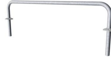
Die Handläufe, die als Griffe bei den Übungen dienen, sind aus feuerverzinktem Stahl mit einem Durchmesser von 38 mm, optimal für einen guten Halt und zur Unterstützung des Handgelenks. Die Höhe des Handlaufs beträgt 940 mm von der Oberseite der HPL-Platte. Der Abstand zwischen den Handläufen beträgt 900 mm.
