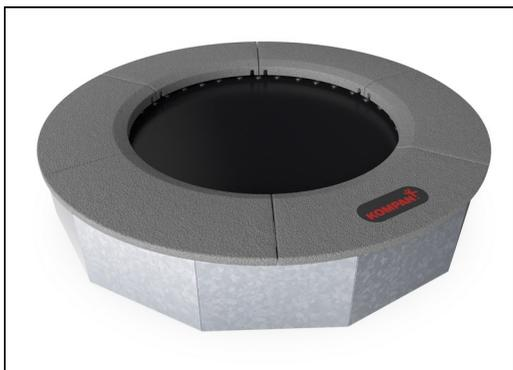
所有钢部件均由碳钢 S235 制成，厚度为 3 毫米。侧板，顶部框架的支撑壁，用 SBR 弯曲的板和用于现场堆焊的平板均经过热浸镀锌处理。
