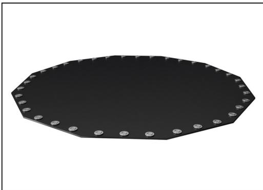
蹦床由 6mm 厚的 EP 乙烯 - 丙烯输送带和聚酯聚酰胺织物胎体制成。弹簧固定装置的两侧均配有钢衬套和垫圈。该膜耐臭氧，并配有 5 个位于中心的排水孔。
