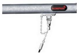
KOMPAN Schwerlast-Schaukelaufhängungen aus rostfreiem Stahl mit Verdrehsicherung. Die Aufhängungen sind mit zwei Bolzen am Querträger auf einer geschweissten Halterung befestigt. Die Lager sind mit Silikonschmiermittel versehen und benötigen keine weitere Schmierung.
