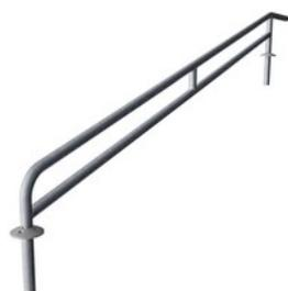
L'altezza della ringhiera è di 930 mm e la distanza tra la ringhiera è di 900 mm. Il materiale utilizzato per la ringhiera è in acciaio zincato a caldo da 38 mm, un grande diametro per una buona presa e supporto per il polso.
