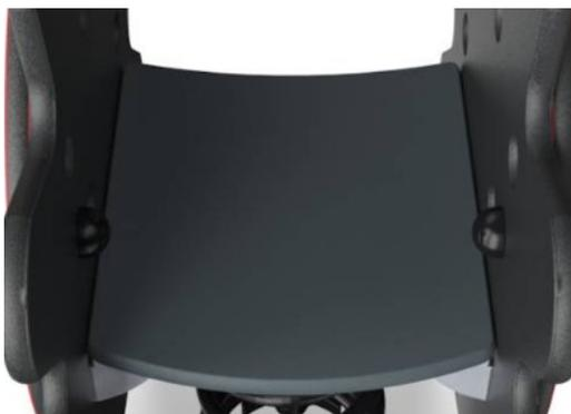
Der Sitz besteht aus einer Ekogrip® Platte, die aus einer 15 mm dicken PE -Fläche und einer 3 mm dicken Gummibeschichtung gefertigt ist, welche für einen Anti-Rutsch-Effekt sorgt.
