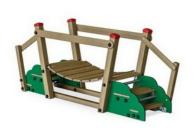
Die Pfosten und Bretter werden aus Kiefernholz aus nachhaltigen europäischen Quellen hergestellt. Das Holz ist druckimprägniert in Klasse 3 mit Tanalith E3475 gemäß EN335 (Äquivalent zu NTR Klasse AB). Auf Anfrage kann es FSC® -zertifiziert (FSC® C004450) geliefert werden.
