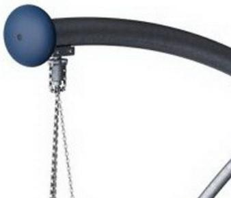
Les suspensions des balançoires au design unique sont en acier inoxydable et ont une rotation à 360 degrés. Les parties mobiles des suspensions sont scellées et lubrifiées à vie. Le système est équipé d'une chaîne de sécurité pour empêcher la chute de la suspension en cas de dommage.
