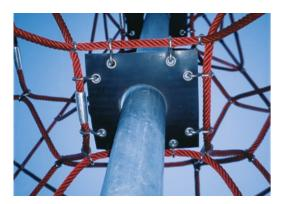
Les membranes Corocord sont constituées d'un matériau caoutchouc résistant au frottement, de qualité équivalente aux tapis roulant et possèdant une excellente résistance aux UV. Testé et conforme aux exigences du règlement REACH en matière de HAP. Une armature à quatre couches en polyester tissé est intégrée. L'épaisseur total de la membrane est de 7.5 mm.
