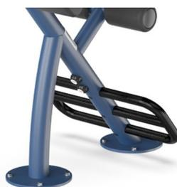
Tous les composants en acier sont fabriqués en acier au carbone, avec une surface galvanisée à chaud selon ISO1461, et un revêtement en poudre classe de corrosion C3 selon ISO12944-2. La teneur en plomb pour les surfaces est inférieure à 90 ppm et inférieure à 100 ppm pour le matériau de base.
