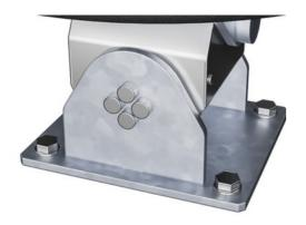
Il doppio elemento ROSTA è realizzato in ghisa e zincato a caldo prima della verniciatura. Ciò garantisce che l'elemento ROSTA sia un giunto elastico esente da manutenzione che può essere spostato nel raggio di movimento di 250 in qualsiasi direzione. Entrambe le oscillazioni hanno una rigidità diversa, la differenza è del 45%.
