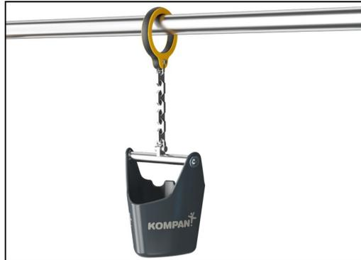
Der Sandeimer wird in einem Stück aus geformtem PE hergestellt. Das PE ist mit 33 % Post-Consumer-Materialien in verschiedenen Farben mit einer Wandstärke von mindestens 5 mm hergestellt. Das Material entspricht der europäischen Norm EN 71-3 und ist auf UV-Stabilität getestet.
