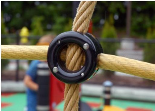
Les filets à escalader sont fabriqués en corde PA avec stabilisation UV et renforcement interne par un câble en acier. La corde est traitée par induction afin d'obtenir une fixation optimale entre l'acier et la corde, offrant ainsi une excellente résistance à l'usure. Tous les connecteurs de corde sont fabriqués en matériaux PA 100 % recyclables.
