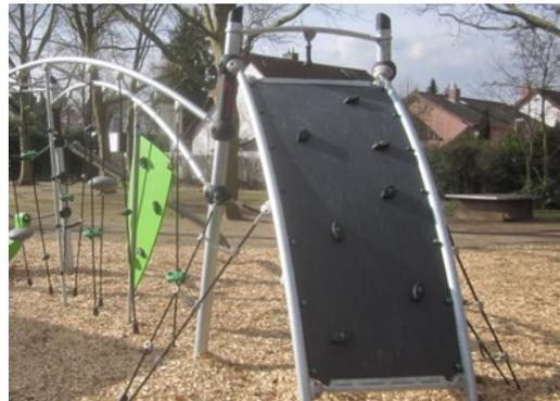
曲面攀爬墙由钢架支撑的 Ekogrip® 面板制成，具有独特设计的攀岩防滑钉。Ekogrip® 面板由 15 毫米厚的 PE 底座和 3 毫米顶层橡胶组成，具有防滑效果。
