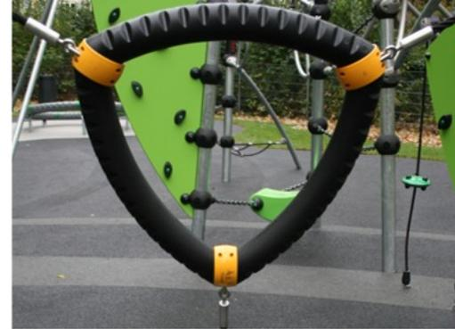
GALAXY 攀登三角架，带有 PUR 的外部软层和模制尼龙（PA6）的角支架。芯部由带有集成角部悬挂点的粉末涂层焊接钢框架组成。较大的三角形由一块 18mm 厚的 Ekogrip® 面板封闭，该面板具有一层橡胶，具有防滑效果。
