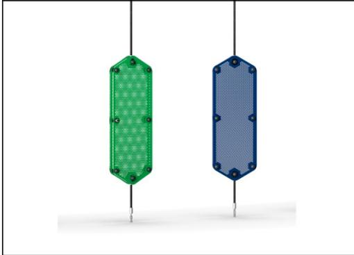
Drehbare optische Spieltafeln aus zwei 7 mm dicken Polycarbonatplatten mit einem Abstand von 40 mm. Der innere Grafikdruck besteht aus einer innen liegenden Bildschicht und einer äußeren transparenten Schutzschicht. Sowohl die PC-Platte als auch der Lack auf Wasserbasis sind UV-stabilisiert, um ein Verblässen des Drucks zu verhindern.
