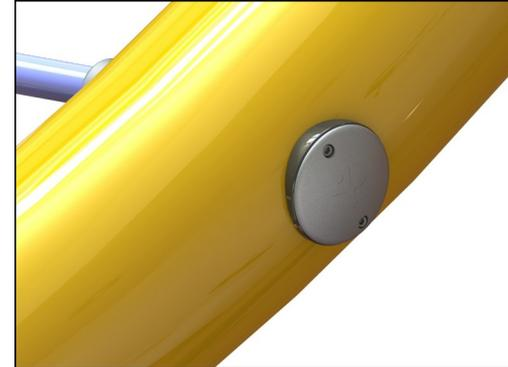
Das Seil wird mit einer einzigartigen, von KOMPAN entwickelten Befestigungs-Lösung an dem großen Stahlrohr befestigt. Sie besteht aus inneren und äußeren Nylonbuchsen (PA6), die das Seil zu einem mit Außengewinde versehenen Teil aus Aluminium führen, das das Seil spannt.
