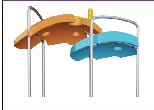
I tetti ELEMENTS sono realizzati in PE riciclabile con uno spessore minimo delle pareti di 5 mm per garantire una lunga durata in tutti i climi del mondo. I tubi in acciaio sono zincati a caldo all'interno e all'esterno per la massima durata.
