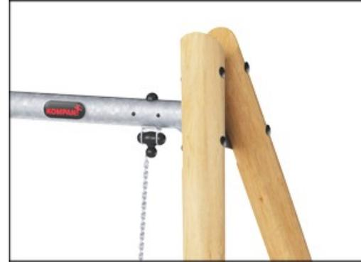
秋千吊架由高质量的 UV 稳定尼龙 (PA6) 外壳制成，并带有集成的全寿命密封球轴承。高度可调节的链条由带有防盗蛇眼螺栓的不锈钢钩固定在可旋转的防扭外壳中。所有带有两个链条固定装置的座椅都可提供标准悬架或防缠绕悬架。
