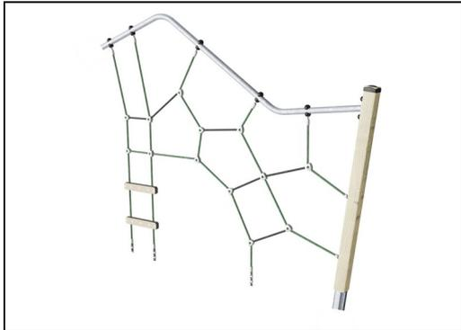
Las redes de cuerda están fabricadas con cuerdas de PES de 16 mm de simple trenzado. El PES tiene una gran resistencia a la abrasión y a los rayos UV. Los circuitos de cuerda se ensamblan mediante conectores de aluminio.
