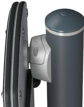
Die Steckverbinder bestehen aus Aluminiumdruckguss, der speziell für den Außenbereich legiert ist und einen Bleigehalt von unter 100 ppm aufweist. Die Verbinder werden mit Schrauben aus rostfreiem Stahl an den Pfosten befestigt und sind durch speziell entwickelte Zinkscheiben gut gegen Korrosion geschützt. Extrem stark und ohne Korrosionserscheinungen.
