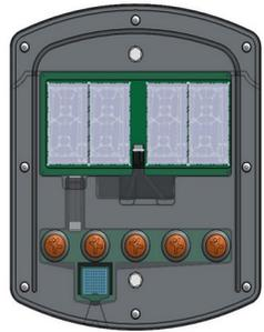
Das reflektierende LCD-Display hat vier Ziffern mit einer Höhe von 100 mm, mit ausgezeichneter Sichtbarkeit im Freien und einem großen Betrachtungswinkel. Ein LCD-Display hat einen niedrigen Energieverbrauch. Es wird von 8 austauschbaren AA-Batterien mit einer Lebensdauer von mehr als 2 Jahren betrieben.
