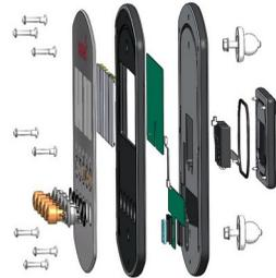
Die Frontplatten sind aus UV-stabilisiertem Polycarbonat hergestellt. Die UV-Stabilisierung verhindert, dass die transparenten Platten im Laufe der Zeit vergilben und gewährleistet die mechanischen Eigenschaften. Die grafischen Aufdrucke werden durch ein einzigartiges mehrschichtiges Druckverfahren hinzugefügt, bei dem die innere Schicht das Bild und die äußere transparente Schicht als Schutz dient. Der Lack ist auf Wasserbasis und UV-stabilisiert, um ein Ausbleichen zu verhindern.
