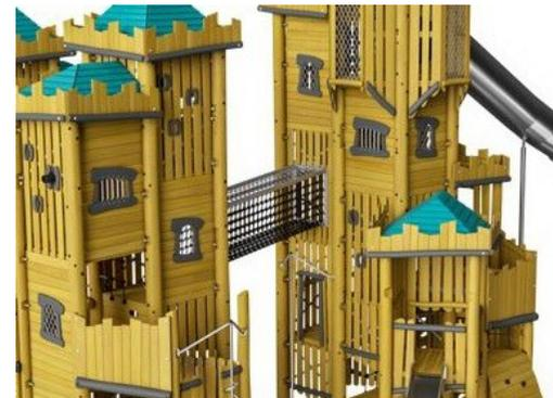
Der Drahtrahmentunnel ist aus feuerverzinktem Qualitätsstahl gefertigt. Corocord 16 mm Seile aus UV-stabilisierten PES-Seilsträngen mit innerer Stahlseilverstärkung. Das Polyestergerüst besteht aus +95 % Post-Consumer-Materialien und wird induktiv auf jede Litze aufgeschmolzen. Die Seile sind sehr verschleiß- und vandalismusbeständig und können bei Bedarf vor Ort ausgetauscht werden.
