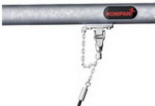
KOMPAN Schwerlast-Schaukelaufhängungen aus rostfreiem Stahl mit Verdrehsicherung. Die Aufhängungen sind mit zwei Bolzen am Querträger auf einer geschweißten Halterung befestigt. Die Lager sind mit Silikonschmiermittel versehen und benötigen keine weitere Schmierung.
