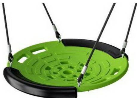
Der Schalensitz besteht aus 100% recycelbarem Polyethylen (PE) und wird in einem Stück rotationsgeformt. Der Sitz ist mit großen äußeren Öffnungen für Griffe und mittig platzierten Löchern zur Ableitung von Wasser und Schmutz ausgestattet. Die vier Seile sind mit feuerverzinkten Stahlhalterungen befestigt, um eine Haltbarkeit über viele Jahre zu gewährleisten.
