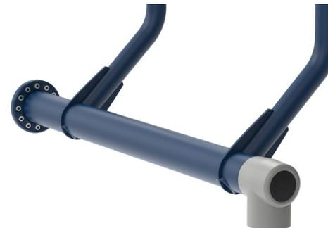
Die Antriebswelle besteht aus  $\varnothing 101,3 \times 2,9$  mm S355 feuerverzinktem und pulverbeschichtetem Stahl. Das Lagergehäuse ist aus Aluminiumguss (EN AB-44100 / EN AB-AISi12(a)) mit selbstausrichtenden, abgedichteten Kugellagern. Eine extrem starke und langlebige Konstruktion
