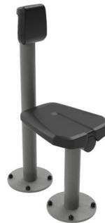
Der Sitz besteht aus Polyurethan-Gummi mit einer elektroverzinkten Stahlplatte, die den Sitz mit dem Rahmen verbindet. Diese Konstruktion macht den Sitz extrem widerstandsfähig gegen Verschleiß und dennoch sehr komfortabel für ein tolles Benutzererlebnis. Der Sitz ist in einer Höhe von 46 cm positioniert, einer komfortablen Höhe, die z.B. den Transfer aus einem Rollstuhl erleichtert.
