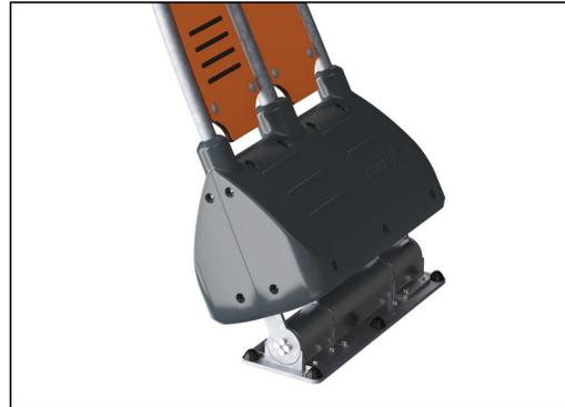
Le mouvement de bascule d'avant en arrière est contrôlé par un double ressort de torsion en caoutchouc à échelle robuste. L'élément en caoutchouc assure un mouvement sûr et réduit la vitesse vers les plateformes de la tour. Le couvercle de base est en PolyÉthylène moulé à haute résistance aux chocs.
