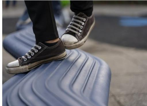
Der Wackelbalken besteht aus PE mittlerer Dichte mit hervorragender Schlagzähigkeit und ist für einen großen Temperaturbereich geeignet. Die hohlen Kunststoffteile bestehen aus 100% recycelbarem PE, das zu 33% aus Post-Consumer-Materialien hergestellt wird. Geformt in einem Stück mit einer Wandstärke von mindestens 5 mm. Die Längsrillen bieten eine rutschfeste Oberfläche für sicheres Spielen.
