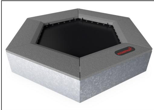
Alle Stahlteile sind aus Carbonstahl S235 in einer Stärke von 3 mm gefertigt. Die Seitenwände, die Stützwände für den oberen Rahmen, die gebogenen Platten mit Styrol-Butadien-Kautschuk (Gummi-Kunststoff) und die flachen Platten für die ebenerdige In-Situ-Montage (bündig mit dem Fallschutz) sind feuerverzinkt.
