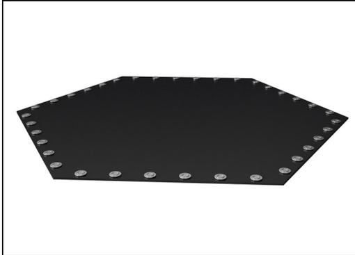
Die Sprungmembranen sind aus 6,0 mm dickem EP-Ethylen-Propylen-Förderband mit Polyester-Polyamidgewebe-Karkasse gefertigt. Die Federbefestigungen sind beidseitig mit Stahlbuchsen und Unterlegscheiben verstärkt. Die Membrane ist ozonbeständig und mit 8 mittig angeordneten Wasserablauföchern ausgestattet.
