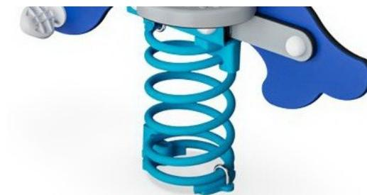
Le molle KOMPAN sono realizzate con acciaio per molle di alta qualità secondo EN10270. Le molle vengono pulite mediante fosfatazione prima di essere verniciate con un primer epossidico e un rivestimento in polvere di poliestere come finitura superiore. Le molle sono fissate da esclusivi raccordi anti pizzico per la massima sicurezza e lunga durata.
