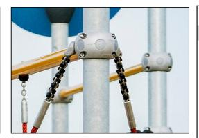
I morsetti intelligenti Corocord sono attentamente progettati in in materiale di alluminio di alta qualità per garantire un'elevata flessibilità. I morsetti intelligenti vengono fissati attorno ai montanti con quattro bulloni in acciaio. I punti di fissaggio non utilizzati vengono chiusi con coperture in poliammide (PA).
