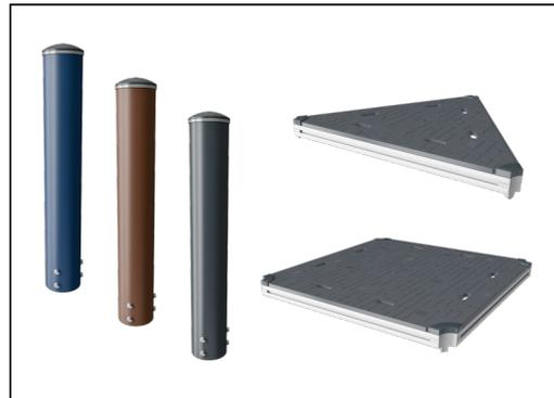
Die Hauptpfosten sind aus hochwertigem, vorverzinktem Stahl mit pulverbeschichteter Oberfläche hergestellt. Die Pfostenoberseiten sind mit Kapfen aus UV-stabilisiertem Polyamid PA6 verschlossen. Die grau gefärbten, spritzgussgeformten Bodenplatten bestehen zu 75% aus recycelten Fischernetzen (PP-Material), und haben ein rutschfestes Muster und eine strukturierte Oberfläche.
