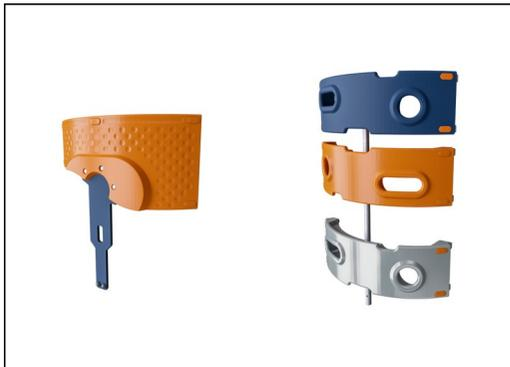
Die dargestellten Kletterelemente sind in einem Stück formgepresst und besitzen eine Wandstärke von 5 mm. Die Kletterelemente sind aus recycelbarem PE mit einer hohen Verschleißfestigkeit und Temperaturbeständigkeit gefertigt. Dies macht diese äusserst vandalismus-beständig in allen Aussenumgebungen.
