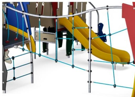
Kletternetze werden aus UV-stabilisiertem PP-Seil mit innerer Stahlseilverstärkung hergestellt. Das Seil ist induktionsbehandelt, um eine maximale Fixierung zwischen Stahl und Seil zu erreichen, was eine ausgezeichnete Verschleiss- und Reißfestigkeit bietet. Alle Seilverbinder sind aus 100% recycelbarem PA-Material hergestellt.
