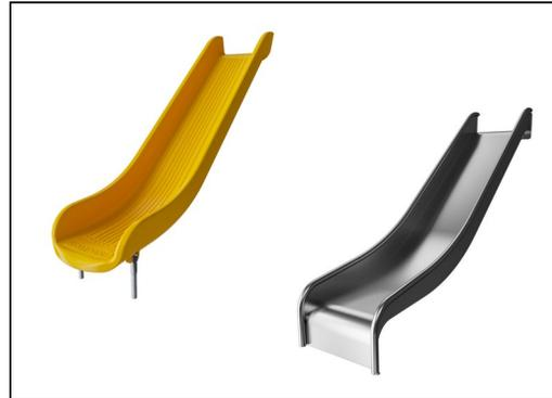
Die Rutschen sind in verschiedenen Materialien erhältlich: In einem Stück formgepresstem PE-LD aus 33 % Post-Consumer-Material und in verschiedenen Farben oder in Edelstahl mit einer Dicke von 2 mm (ANSI 304).
