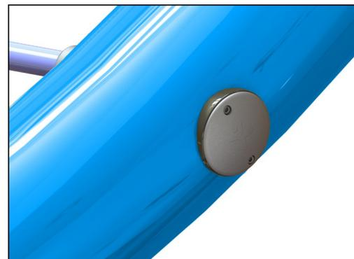
La fune è fissata al tubo in acciaio da un'esclusiva soluzione di serraggio progettata da KOMPAN. È costituito da boccole interne ed esterne in nylon (PA6) che guidano la fune verso una parte esterna in alluminio filettata che tira la fune.
