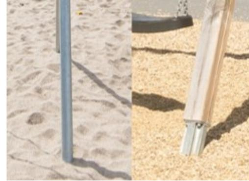
Los postes de los columpios con bastidor en A están disponibles para el anclaje de superficie con pernos de expansión o enterrados a 60 cm o 90 cm de profundidad. Las patas de acero galvanizado en caliente están ancladas directamente en el suelo. Los postes de madera de pino se elevan del suelo mediante una zapata de acero galvanizado en caliente perfilada única.
