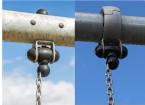
Los colgadores de los columpios están hechos de una carcasa de nylon de alta calidad estabilizada contra rayos UV (PA6) con rodamientos de bolas sellados de por vida integrados. Las cadenas ajustables en altura se fijan mediante un gancho de acero inoxidable con perno de ojo de serpiente antirrobo en una carcasa giratoria antivuelco. Todos los asientos con fijación de dos cadenas están disponibles con suspensión estándar o anti-envoltura.
