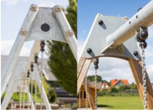
El bastidor A está diseñado con una barra transversal de  $\varnothing 100$  mm galvanizada en caliente con grandes placas finales de acero para una fijación fuerte de las dos opciones de postes: acero galvanizado en caliente de  $\varnothing 70$  mm. Madera de pino impregnada con zapatas de acero galvanizado en caliente.
