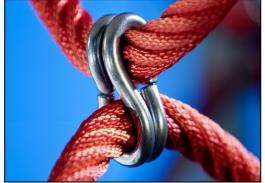
Las abrazaderas Corocord 'S' se utilizan como conexiones universales en los productos Corocord. Las varillas de acero inoxidable de 8 mm con bordes redondeados se presionan alrededor de las cuerdas con una prensa hidráulica especial, lo que las convierte en el conector idel: seguro, duradero y a prueba de vandalismo, todo mientras permite el movimiento típico de las estructuras de juego de la cuerda.
