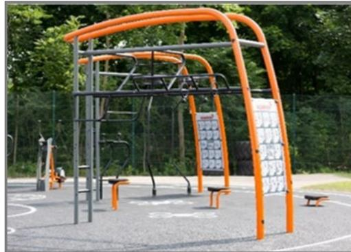
为保证主体框架的完整性，橙色主立柱由 Ø101.6 x 3 毫米钢立柱构成，它是热浸镀锌的，拥有橙色 (RAL2010) 的粉末涂层。支撑立柱接受相同的表面处理，由 Ø76.1 x 3.6 毫米的钢管构成，灰色 (RAL7012) 粉末涂层。
