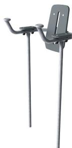
Le cadre de l'élévateur de jambe est en tube d'acier HDG Ø38 x 2 mm. Les plaques de support sont en Ekogrip® de 15 mm, une plaque en PE de 15 mm avec une couche supérieure de 3 mm de caoutchouc thermoplastique à effet antidérapant. Les supports de bras mesurent 110 x 195 mm, espacés de 580 mm et 1315 mm au-dessus du sol. Le support dorsal mesure 335 x 500 mm. L'ouverture à l'arrière est de 30 x 350 mm.
