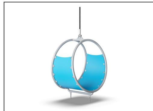
Hangout pod conçu avec un cadre soudé de deux anneaux en acier galvanisés à chaud et revêtus de poudre. La membrane est constituée d'un matériau caoutchouté résistant au frottement de la qualité de la bande transporteuse avec une excellente résistance aux UV.
