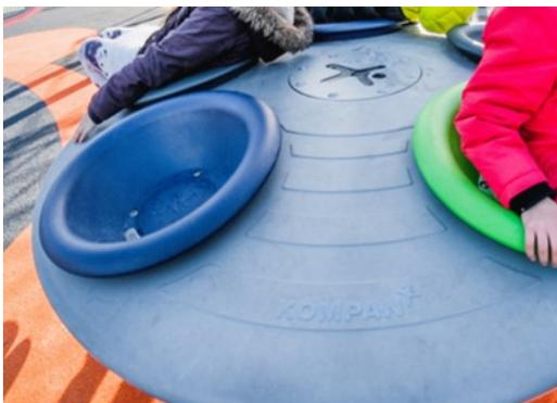
La base gris Multispinner está hecha de PE reciclable. La base está moldeada en una sola pieza con bujes de rosca de metal integrados y orificios de drenaje de agua para garantizar una alta durabilidad en todos los climas del mundo. Cada cuenco se monta por separado en la base.
