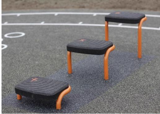
支撑架是  $\varnothing 48.3 \times 4$ mm, 碳钢, 热浸镀锌表面根据 ISO1461 标准, 粉末涂料腐蚀等级 C3 符合 ISO12944-2。表面铅含量低于 90ppm。
