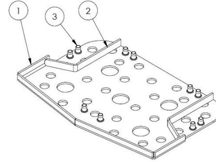
5mm 的热浸镀锌碳钢板在 SBR 内部模压成型, 该 SBR 提供最佳的稳定性, 优化其与框架的连接。
