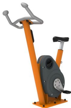
框架的前管由 S235 热浸镀锌钢管制成，规格为  $\text{Ø}76.1 \times 3.6\text{mm}$ ，并符合 ISO12944-2 标准的 C3 防腐等级粉末涂层。
