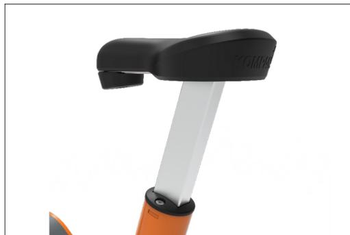
座椅采用注塑成型的软聚氨酯 (PUR) 材料，内嵌有粉末涂层的 S235 钢制钢板。用户可以在 9 种不同的座椅高度中选择，范围为 845mm 至 995mm。座椅设计适合身高在 150cm 至 195cm 之间的用户，提供舒适的骑行体验。
