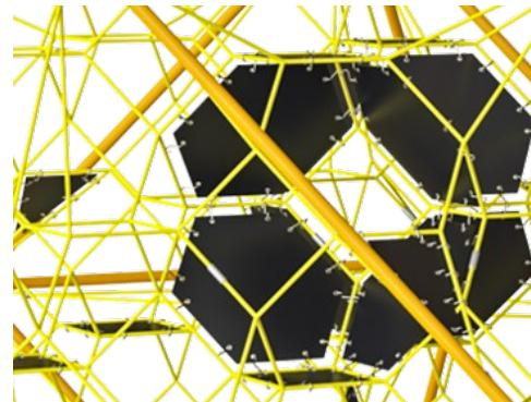
„S“ svorky Corocord se u produktů Corocord používají jako univerzální spojovací prvek. 8mm nerezové dráty se zaoblenými konci jsou za pomoc speciálního hydraulického nástroje nalisovány kolem lana, což z nich dělá ideální konektor: bezpečný a odolný proti vandalismu s dlouhou životností, to vše s umožněním typického pohybu lanových herních struktur.
