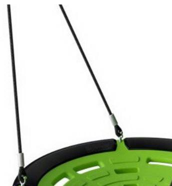
Le siège de la coque est en polyéthylène (PE) 100% recyclable et rotomoulé en une seule pièce. Le siège est conçu avec de grandes ouvertures extérieures pour les poignées et des trous intermédiaires pour le drainage de l'eau et de la saleté. Les 4 cordes sont fixées avec des supports en acier galvanisé à chaud pour assurer une durabilité pendant de nombreuses années.
