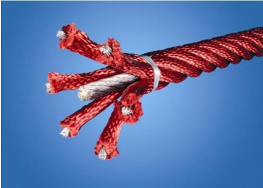
Die Seile des Saturn Karussells bestehen aus verzinkten, sechslitzigen Stahldrahtseilen, die mit einem Stahlkern versehen sind. Jede Litze ist mit PES-Garn umwickelt, das induktiv auf jede Litze aufgeschmolzen wird und aus +95 % Post-Consumer-Material besteht. Nach Abrieb der Garnfasern verbleibt eine härtere PES-Schicht, die die Drahtlitzen schützt. Damit sind die Seile äusserst beständig gegenüber Abnutzung und Vandalismus.
