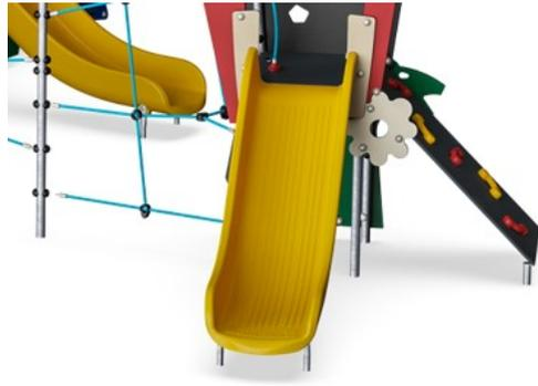
Die Rutsche besteht aus geformtem PE (Polyethylen) aus 33% Post-Consumer-Materialien in einem Stück mit einer Wandstärke von mindestens 5 mm und in verschiedenen Farben. Das PE ist auf UV-Beständigkeit getestet und hat eine ausgezeichnete Schlagzähigkeit und ist innerhalb einer großen Temperaturspanne verwendbar.
